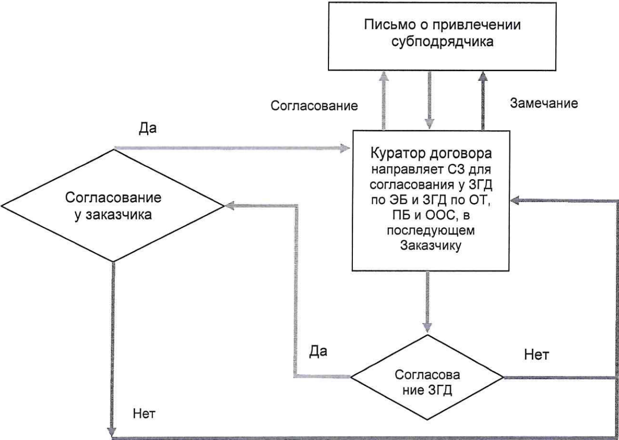
Приложение 6 Блок схема процесса согласования субподрядчика
